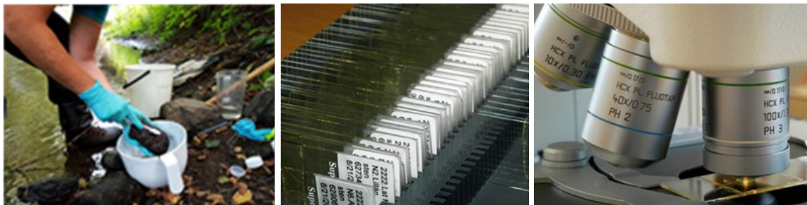
Figur 1. Provtagning av kiselalger görs i första hand från sten genom att påväxten borstas av. Kiselalgsskalen prepareras fram och fixeras på objektglas. Kiselalgsanalys görs i ljusmikroskop i 1000 gångers förstoring med oljeimmersionsobjektiv. Mikroskopet ska helst vara utrustat med interferenskontrast, vilket gör att man kan se mycket små former tydligare än med andra tekniker.
