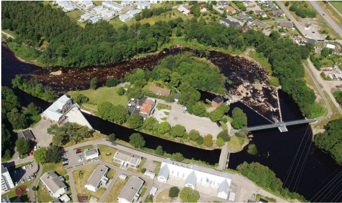
Figur 1. Falkenbergs kommuns flygfoto. De två sprängda kanalerna vid Hertings båda kraftverk syns tydligt, liksom den gamla åfåran som är fiskvandringsled med minst 11 kubikmeter vatten per sekund.
