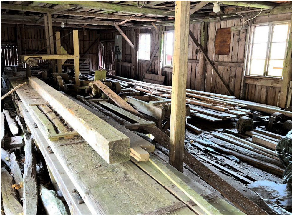
Figur 32. Invändigt syns remtransmissionsdriften för den maskinella utrustningen.
